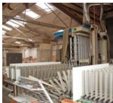
... ein Bohrzentrum der Marke Bre.Ma und eine Kantenanleimmaschine machen die Hauptarbeit
